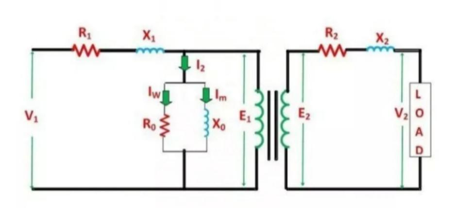
Equivalent Circuit of Transformer (Reference: circuitglobe.com)
