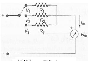
fig 4.2 Multirange Voltmeter
