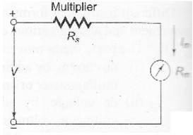
fig 4.1 Basic Voltmeter
